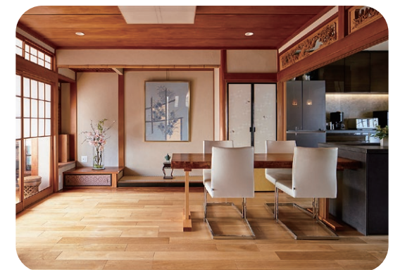
1階DK。真壁造りで現しの柱や梁、目透かし天井の経年した色目にも馴染みやすいオークの床。
